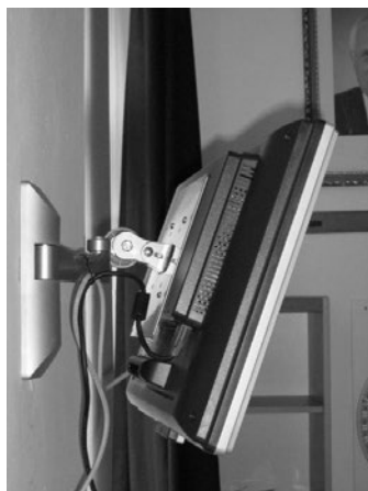
Obrázek 1.6: Uchycení monitoru pomocí stavitelného nástěnného držáku VESA. Je vidět možnost naklápění a otáčení dle potřeby.
